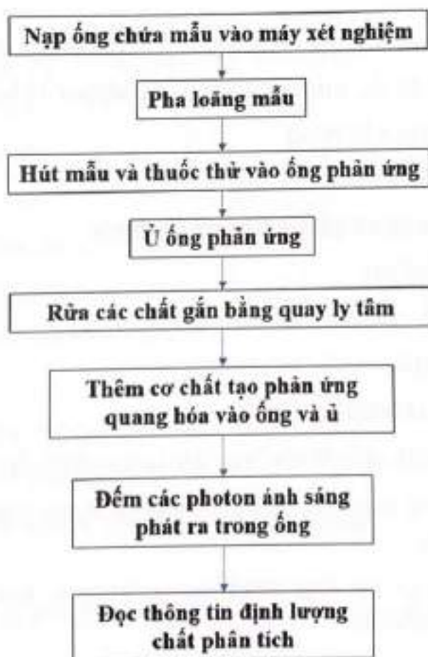
Hình 10.27. Quy trình thực hiện xét nghiệm ECL
