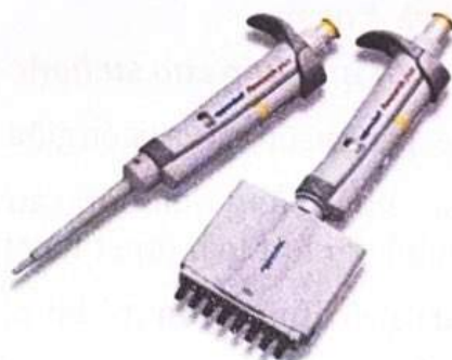
Hình 2.8. Pipet tự động một kênh và nhiều kênh
