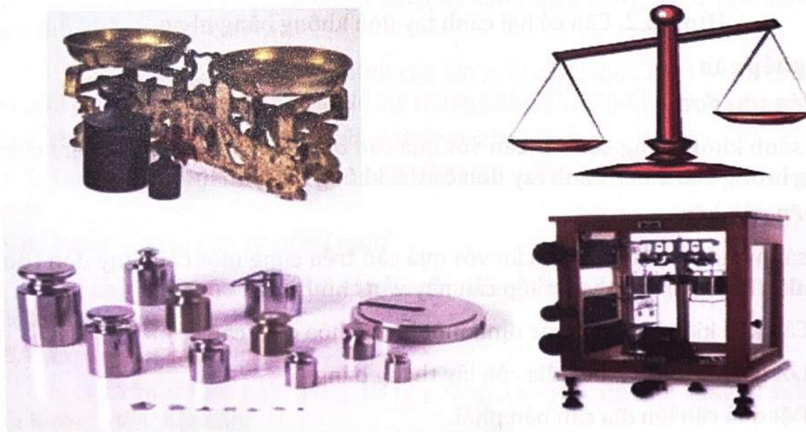
Hình 2.1. Cân có hai cánh tay đòn bằng nhau
